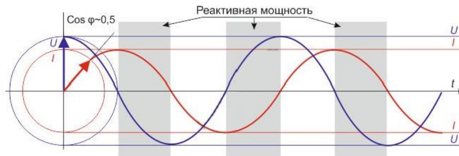
Рисунок 2 – Сдвиг фаз тока и напряжение при \cos\varphi=0,5
