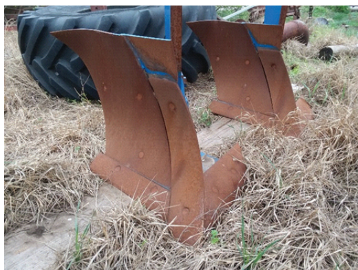
Рис. 2. Корпус с комбинированными универсальными рабочими органами плуга ПСКУ-5
