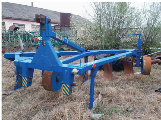
Рис. 1. Плуг скоростной комбинированный универсальный ПСКу-5 тракторной бригады ООО «Агропарк»
