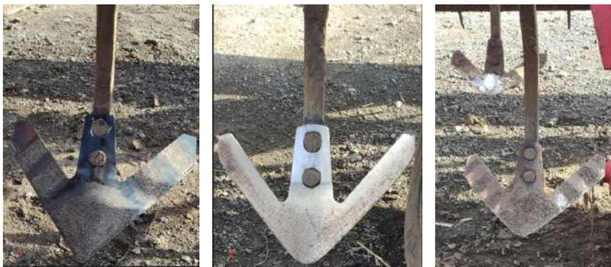
Рис. 3. Установленные упрочненные рабочие органы на культиватор Chervona Zyrka POLARIS 8,5 при полевых испытаниях
