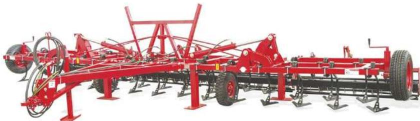
*Рис. 1. Паровой широкозахватный культиватор Chervona Zyrka POLARIS 8,5 с упрочнёнными стрельчатыми лапами*
