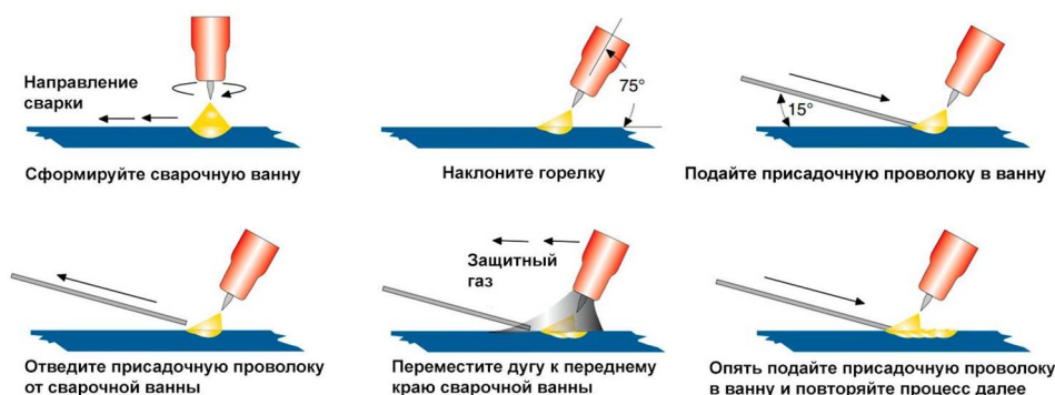
Рис. 2. Процесс аргонодуговой сварки
