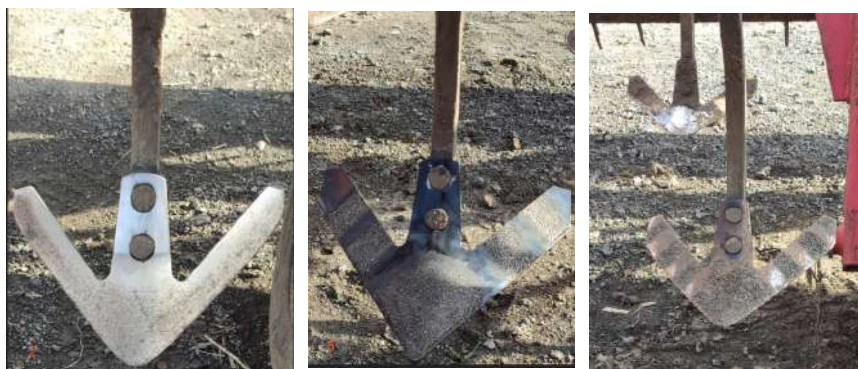
Рисунок 5. Установленные упрочненные рабочие органы на культиватор Chervona Zyrka POLARIS 8,5 при полевых испытаниях
