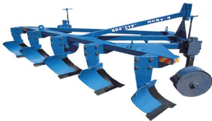
Рисунок 2. Плуг скоростной комбинированный универсальный ПСКУ-5 с установленными отвальными корпусами, укомплектованными режущими лемехами
