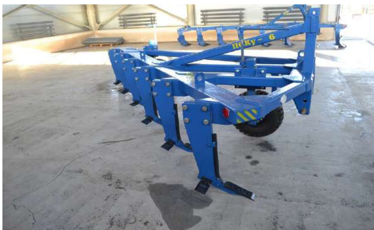
Рисунок 3. Плуг скоростной комбинированный универсальный ПСКУ-5ЧГ с установленными чизельными стойками и рабочими органами
