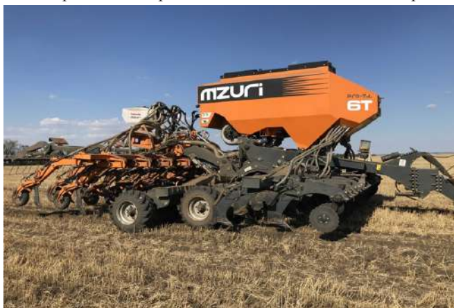
Рисунок 6. Шестиметровый посевной однопроходный многофункциональный комплекс Mzuri Pro-Til 6T Select для полосовой обработки почвы
